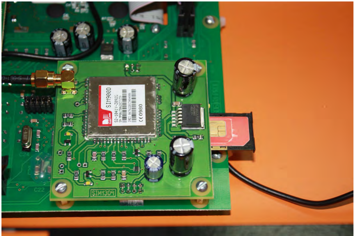
Рис.8.1. Установка лотка на место.
